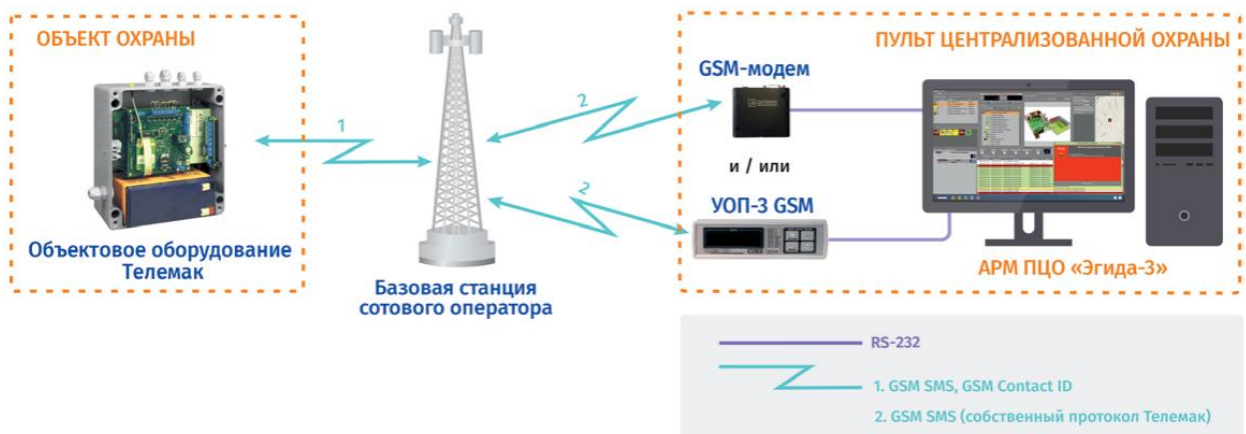
Рис. 1 Схема работы с приборами Телемак в Эгида-3
